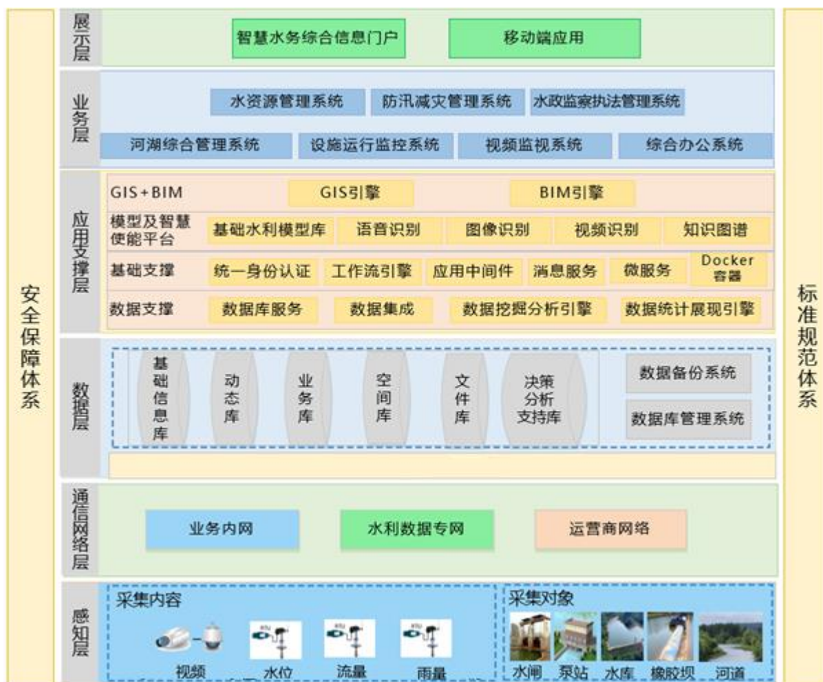
图 8.1-1 开封城市智慧水利系统总体架构图
