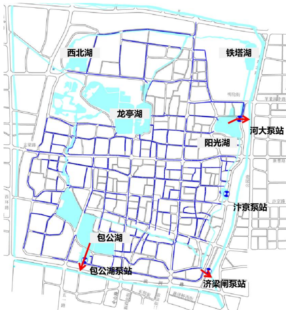
图 6.2-3 老城区湖泊位置及联排联调平面示意图
